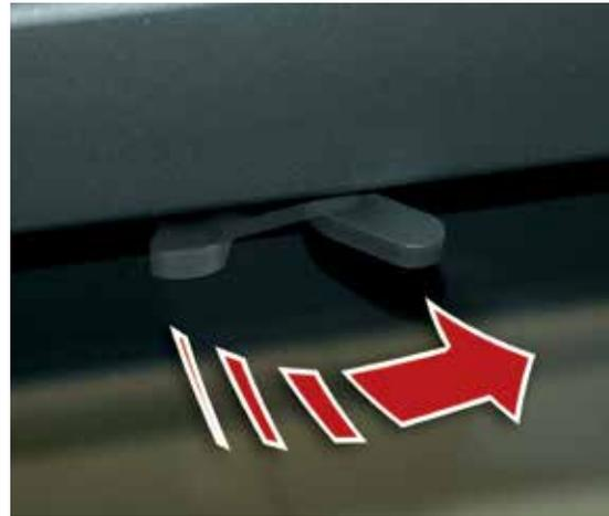
Komforthebel zur Scheibenreinigung. Für schnelles öffnen ohne Werkzeug in nur 5 Sekunden.
