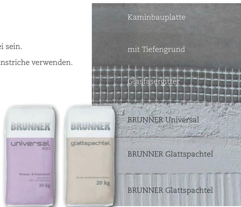
Putzfläche in Ausführung mit BRUNNER Universal 600. In die naturweiße Putzfläche ist ein Glasfasergitter mit 6 mm Maschenweite eingearbeitet. Die glatte bzw. modellierte Oberfläche wird mit BRUNNER Glattspachtel erstellt.
