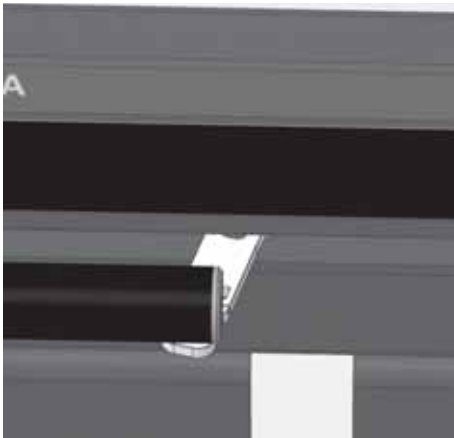
Abb. 3.6 Luftschieber ganz links – 0 %, Verbrennungsluft geschlossen
