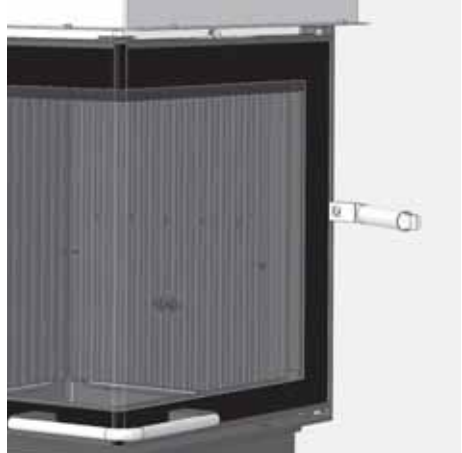
Abb. 3.45 separater Bediengriff seitlich eingesteckt
