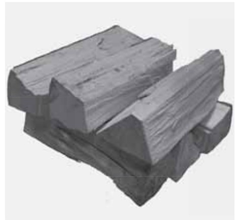
Abb. 3.10 Holzscheite für das Anheizen – ungefähr entsprechend der Holzaufgabe bei Nennwärmeleistung
