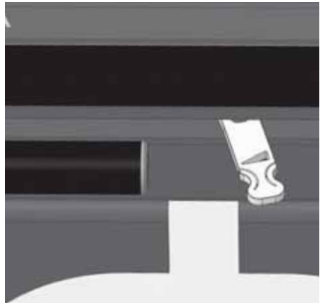
Abb. 3.15 Luftschieber ganz rechts, über den Anschlag hinaus, in Anheizstellung
