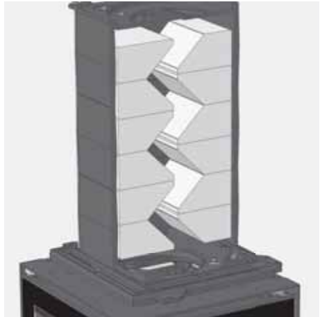
Abb. 3.50 Guss-Speicheraufsatz, Heizgasführung, Schnittdarstellung
