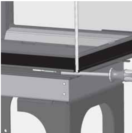
Abb. 3.48 Einsatzstück mit flachem Schraubendreher heraushebeln
