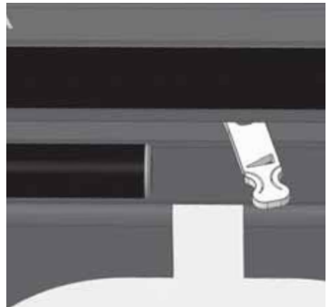
Abb. 3.14 Luftschieber ganz rechts, über den Anschlag hinaus, in Anheizstellung
