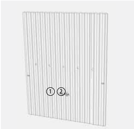
Abb. 4.8 Feuerraumauskleidung KALA QS, KALA PS oder KALA US, Gussteil
