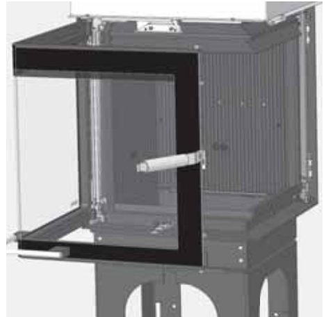
Abb. 3.46 Tür für die Reinigung ausgeschwenkt bei KALA H ES 45
