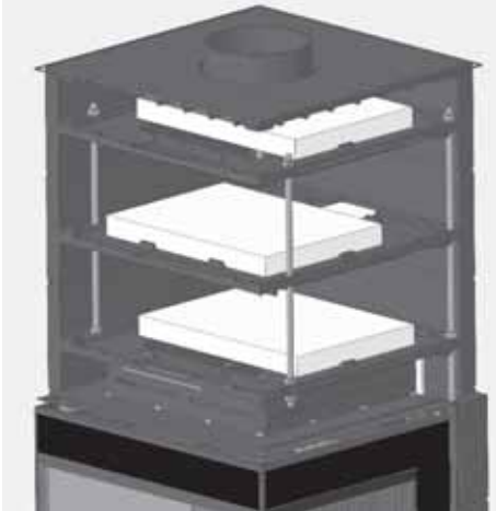
Abb. 4.32 Lage der Umlenkungen beim CORNA PS
