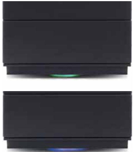
Abb. 4.23 LED-Lichtsignal zunächst „GRÜN“ dann „BLAU“
