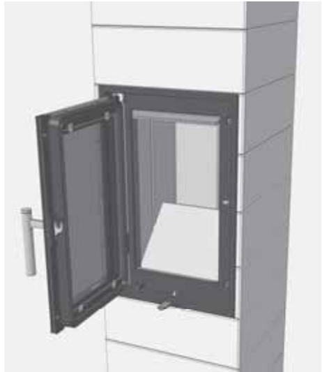
Abb. 4.28 Entnehmen des Bodensteins im Brennraum
