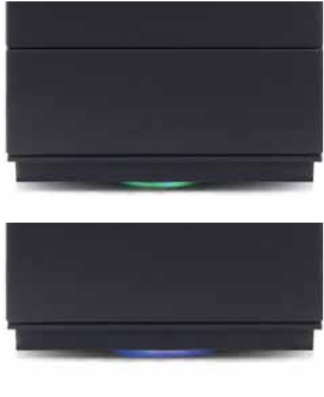
Abb. 4.24 LED-Lichtsignal zunächst „GRÜN“ dann „BLAU“
