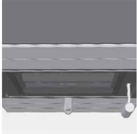
Abb. 4.9 Verbrennungslufthebel mittig, Verbrennungsluft auf Nennwärmeleistung
