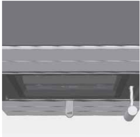
Abb. 4.5 Verbrennungslufthebel mittig, Verbrennungsluft auf Nennwärmeleistung
