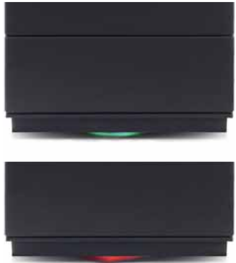
Abb. 4.25 LED-Lichtsignal zunächst „GRÜN“ dann „ROT“
