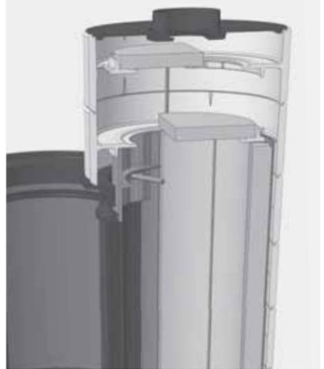
Abb. 4.36 Entnehmen der Umlenkungen (Heizgasführung)
