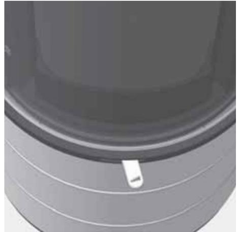
Abb. 4.6 Verbrennungslufthebel ganz rechts, Verbrennungsluft komplett geöffnet, Anheizen
