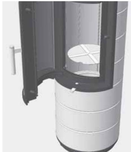
Abb. 4.34 Entnehmen des Bodenblechs im Brennraum
