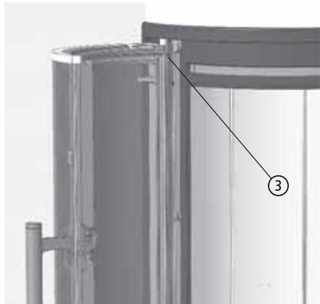
Abb. 3.8 Madenschraube, Stiftsicherung lösen
