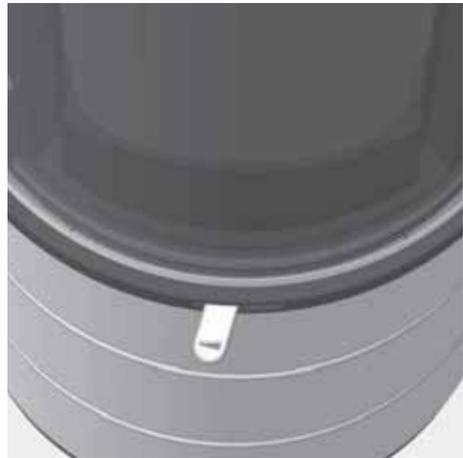
Abb. 4.7 Verbrennungslufthebel ganz links, Verbrennungsluft geschlossen
