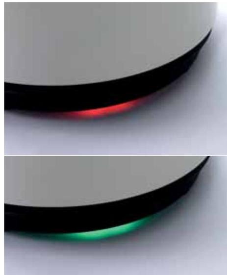
Abb. 4.28 LED-Lichtsignal bei Betrieb „ROT“ dann wieder „GRÜN“
