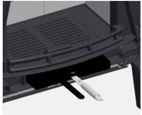
Abb. 4.17 Aschekasten mit Bediengriff herausziehen
