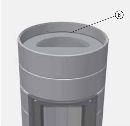
Abb. 3.24 umlaufende Kittfuge über zweiten Speichereinlage
