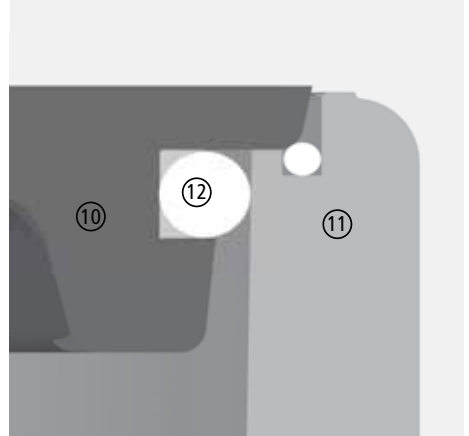
Abb. 3.28 Dichtnut im obersten Gussring, Dichtprofil der Abdeckung
