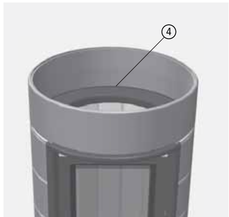
Abb. 3.21 umlaufende Kittfuge in erstem Gussring
