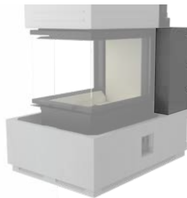
16. Seitenteil (mit integrierter Hinterlüftung) ohne zu Verkleben von oben, mit der Sichtseite außen bündig auf das Unterbauteil setzen. Hinterlüftung zur Wandseite!
