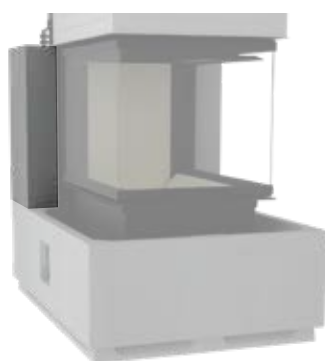
17. Zweites Seitenteil ohne zu verkleben auf das Unterbauteil setzen und ausrichten (Kamineinsatz evtl. nachjustieren). Tragrahmen wieder montieren.
