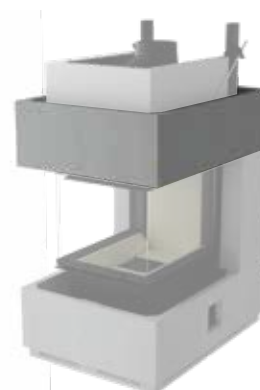
18. Erstes Oberbauteil ohne zu Verkleben mit der Falzseite von oben auf den Tragrahmen setzen und ausrichten. Tragrahmen ggf. nachstellen.
